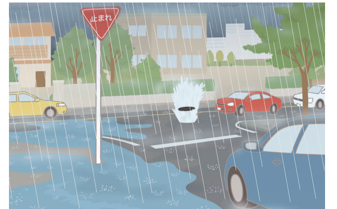
車両交通の多い車道部におけるマンホールからの下水の噴出
