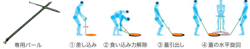
専用バール ①差し込み ②食い込み力解除 ③蓋引出し ④蓋の水平旋回
